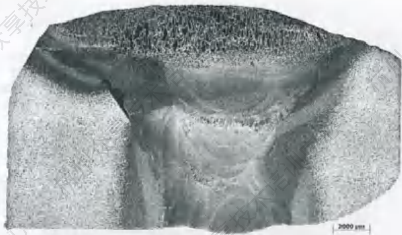
图 A.3 坡口未熔合 (三)
