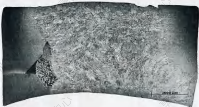
图 A.1 坡口未熔合 (一)
