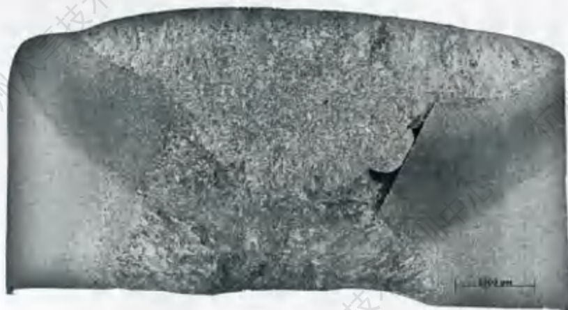
图 A.2 坡口未熔合 (二)
