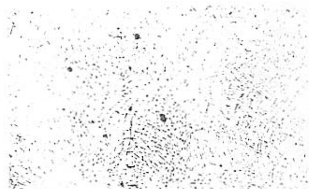
d 小孔洞周围的不合格 1型 \alpha 偏析 35 \times
